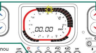
přestavte přepínač polohy AUTO do polohy PROG.
